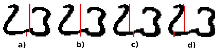
FIG. 17 – Les 4 variantes de l'algorithme "drop fall" : a) ascendant gauche b) ascendant droit c) descendant gauche d) descendant droit.
