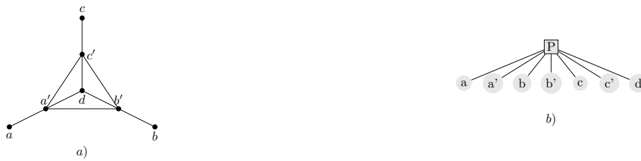
FIG. 1.9: Limite de la décomposition modulaire a) le graphe G b) l'arbre de décomposition modulaire de G . On ne peut déduire de cet arbre les relations qui peuvent exister entre les fils du noeud P .
